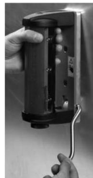
Bevor sie den Empfänger an den Löffelstiel anbringen, drücken sie den Freigabehebel nach unten.
