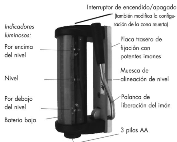
Para la puesta en marcha: pulse el interruptor de encendido/apagado situado en la parte superior del aparato.
