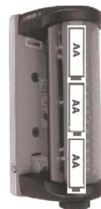
Le récepteur nécessite 3 piles AA. Dévisser le couvercle noir situé au bas de l'appareil pour changer les batteries, et les replacer dans la position indiquée. La durée d'utilisation est d'environ 130 heures.
