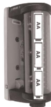
Der Empfänger braucht 3 St. AA-Batterien. Schrauben sie die schwarze Kappe unten am Gerät ab um die Batterien auszutauschen; angeordnet wie beschrieben. Die Betriebsdauer beträgt ca. 130 Stunden.
