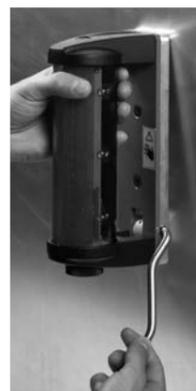
Antes de conectar el receptor al brazo mecánico, bascule la palanca de desacoplamiento hacia abajo. Esta maniobra crea un espacio entre la tarjeta maestra y la máquina y evita que el imán se adhiera totalmente al metal.
