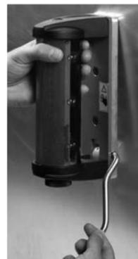
Avant de raccorder le récepteur au bras mécanique, basculez le levier de désaccouplement vers le bas. Cette manœuvre crée un espace entre la carte mère et la machine et empêche que l'aimant adhère totalement au métal.
